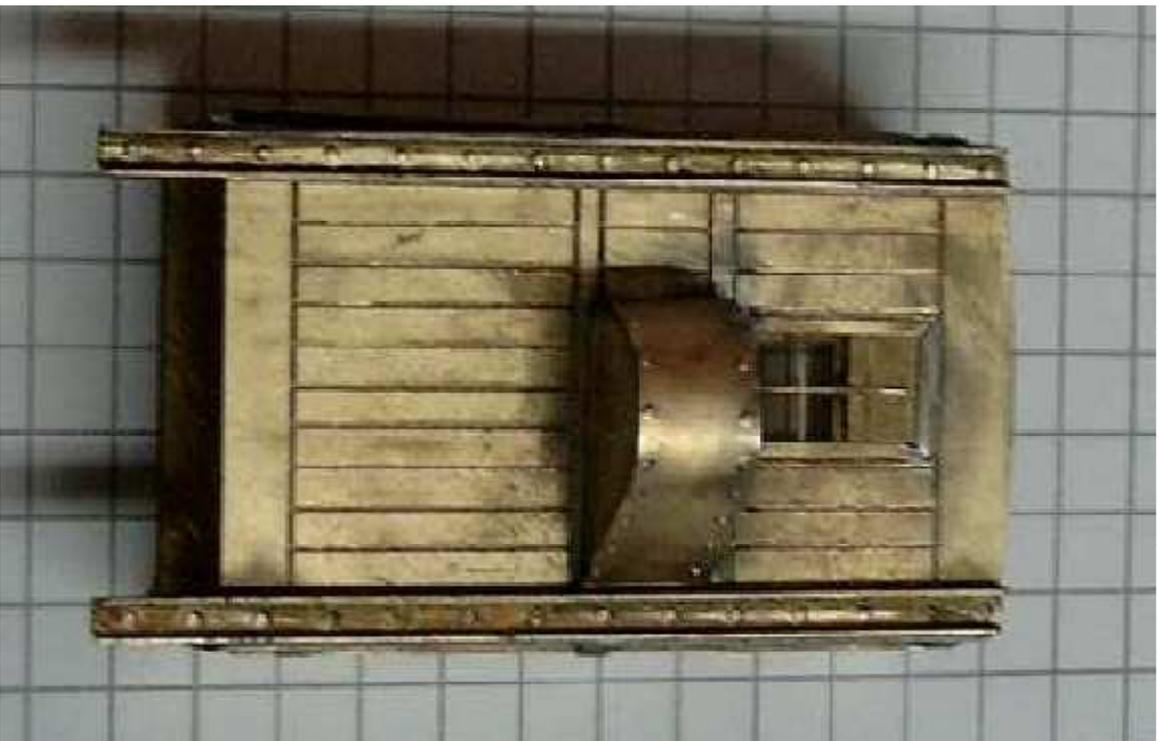
**Setzen Sie die längeren Profile vorne an das Bremserhaus.**
