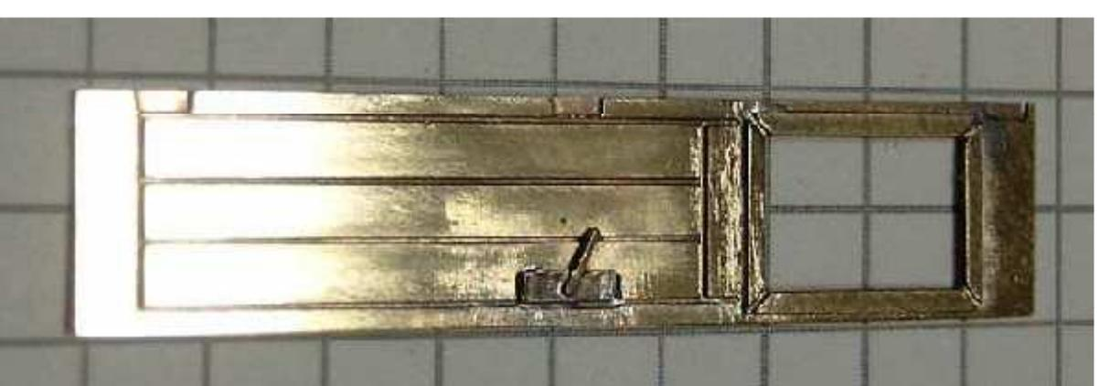
**Die beiden anderen Fensterrahmen werden in die vorgesehenen Anätzungen des Bremserhauses eingesetzt. Die Türen einsetzen. Die Scharniere einsetzen.**
