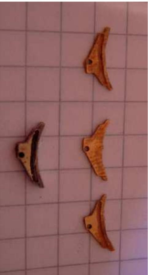
**Die Aufnahme für die Bremsklötze, wie auf dem Bild zu sehen ist, biegen und die Bremsklötze einsetzen.**
