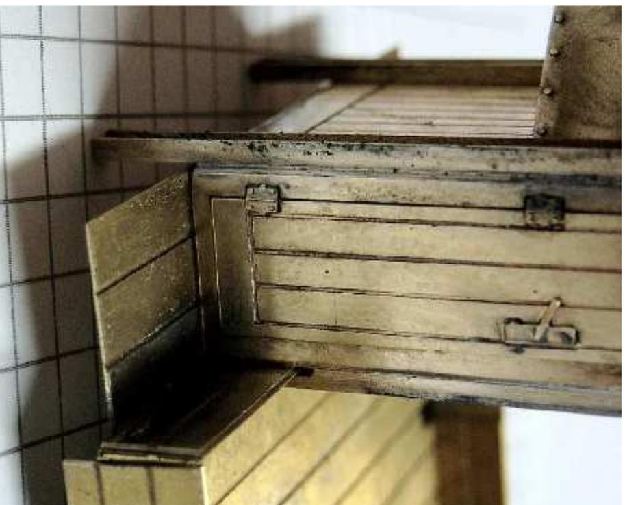
**Legen Sie das Nietband in das gekantete U-Profil ein. Es sollte, wenn möglich eingeklebt werden.**
