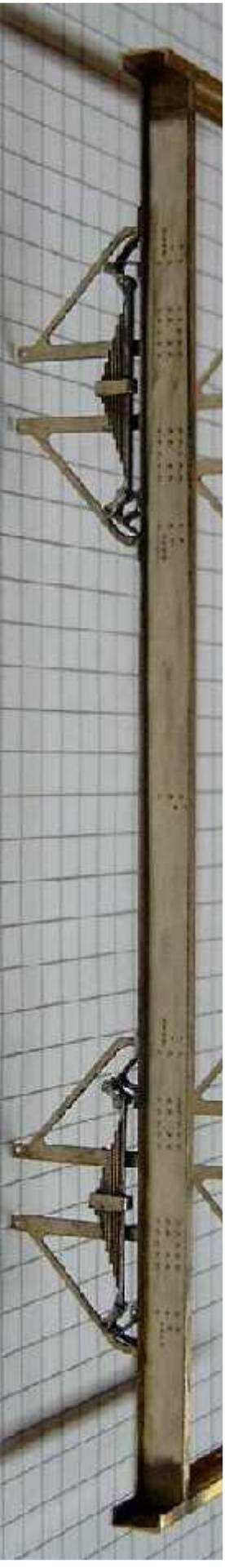
**Trennen Sie die Kastenstützen heraus und kanten Sie diese, wie auf dem Bild zu sehen ist. Verlöten Sie die Stoßkanten. Das vordere Stück dient als Biegehilfe. Es muss nach dem Zusammenlöten herausgetrennt werden.**
