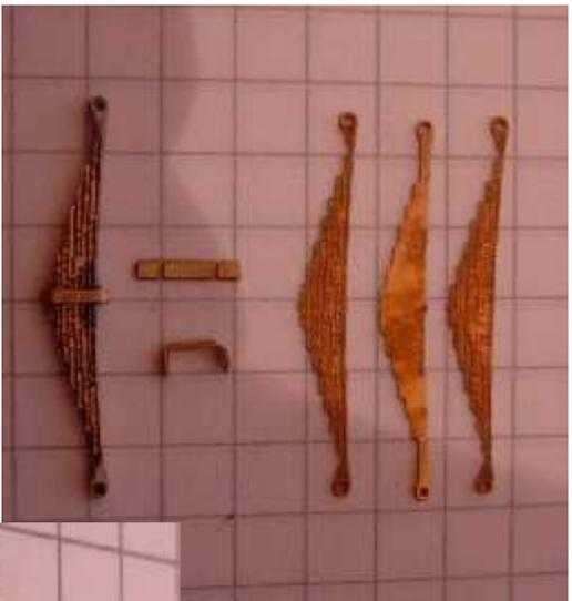
**Die Federn müssen nun montiert werden. Dazu legen Sie jeweils 3 Stück übereinander und verlöten diese zu einem Federpaket. Die Federklammern , wie auf dem Bild dargestellt biegen und auflöten. Setzen Sie jeweils ein Stückchen Messingdraht in die Löcher ein und verlöten diese. Etwas Geschick erfordert der Zusammenbau der Federböcke. Die Federböcke herausstrennen und wie auf dem Bild zu sehen ist, mit dem eingefügten Messingdraht biegen.**
