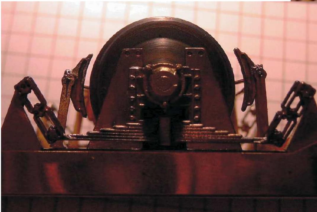
Setzen Sie jetzt die Achsen mit den Rollenradlagern ein. Richten Sie die Bremsbacken so ein, dass sie mit dem Rad nicht in Berührung/Kontakt kommen.
