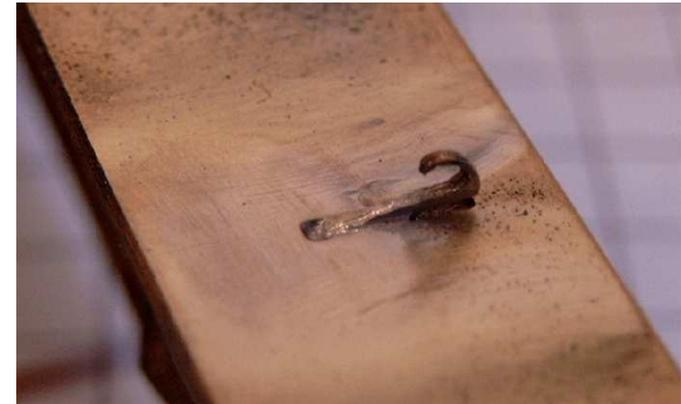
Auflöten der Zughaken (Teile 27) in die Anätzungen der Oberplatte zwischen den Winkeln
