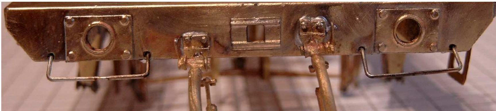
Aufbringen der Pufferplatten und der Kupplungsführung (Teile 28) auf einer Seite des Wagens.
