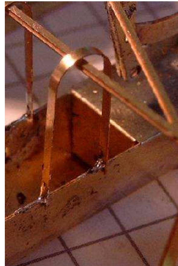
Die Halterung für den Bremshebel (Teil 19) wird an der Knickkante um 90 Grad gebogen und auf die Anätzung des Grundrahmens aufgelötet.
