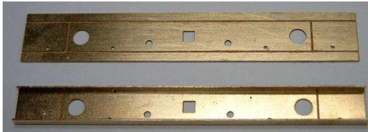
Die Radlagerverstärkungen heraustrennen. Die entgrateten Bleche werden um 90 Grad gebogen und in die Anätzungen der Achshalter eingelötet. Nach dem Einlöten muss die Höhe noch angepasst werden. Dazu benutzen Sie die Radlager.
