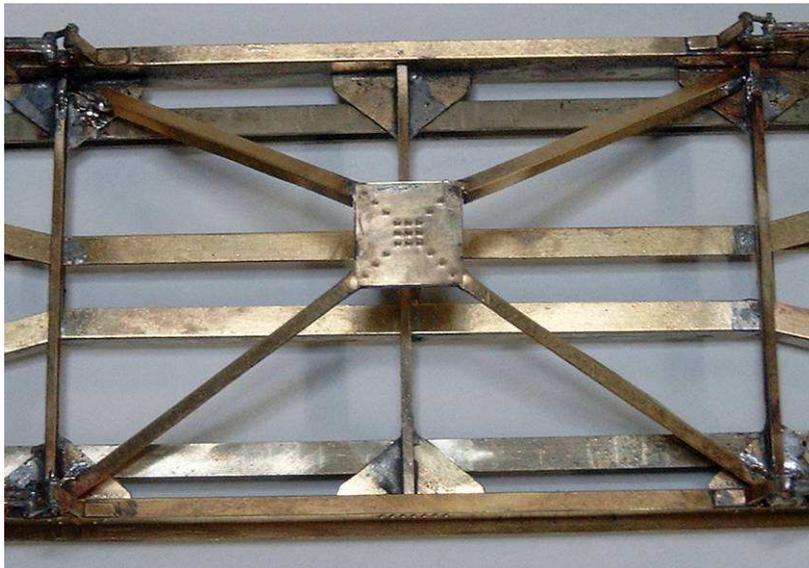
**Das Knotenblech mittig auf das Sprengwerk auflöten. Das Sprengwerk abkanten.**
