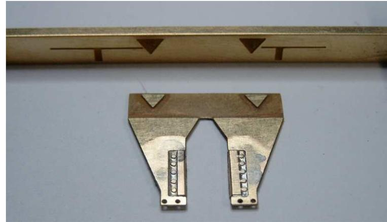
Die auf einem Extrablech beigefügten Schakenböcke müssen jetzt gekantet werden. Da es etwas schwierig ist, diese zu kanten, liegt die doppelte Menge bei.
