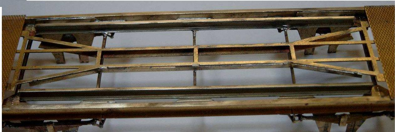
**Die Nietenbänder werden in die Längsträger eingelegt. Diese am Besten einkleben.**
