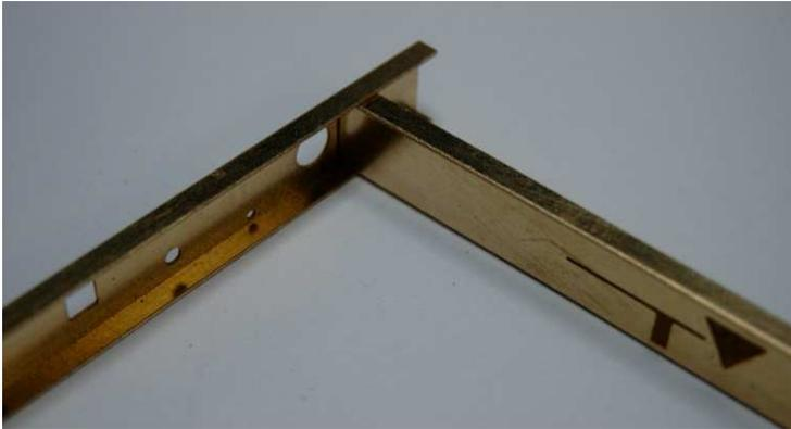
Die Achshalter in die Anätzungen der Längsträger einlöten.
