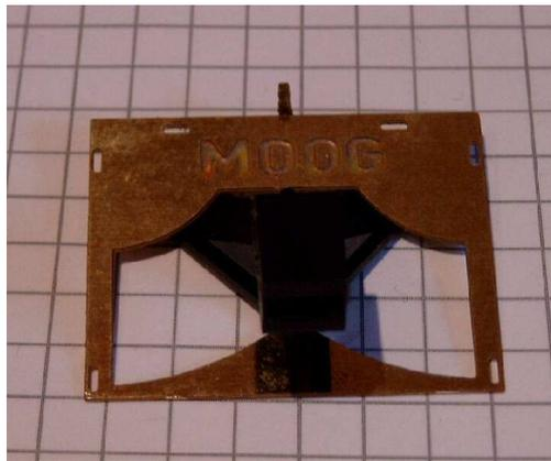
Nach dem Einsetzen auf das Grundgehäuse, biegen Sie die 6 Laschen nach innen um.
