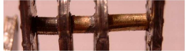
**Trennen Sie jetzt die Griffstangen aus der Grundplatte heraus. Die oberen Ösen müssen jetzt um 90 Grad gedreht werden. Dabei ist zu beachten, dass alle Ösen in die gleiche Richtung gedreht werden.**
