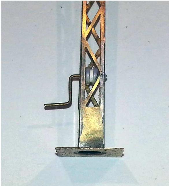
**Die zweite Rolle mit einem Stück Messingdraht in die untere Ecke des Auslegers einlöten.**
