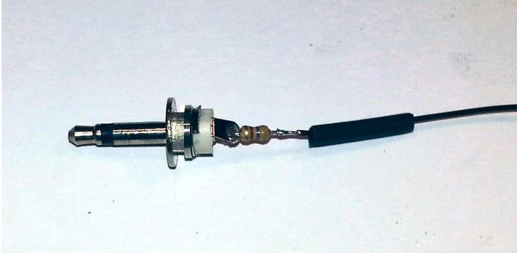
Das Kabel mit einem dünnen Draht durch den Gittermast durchziehen. Den Stecker in die Bodenplatte einsetzen und verlöten.
