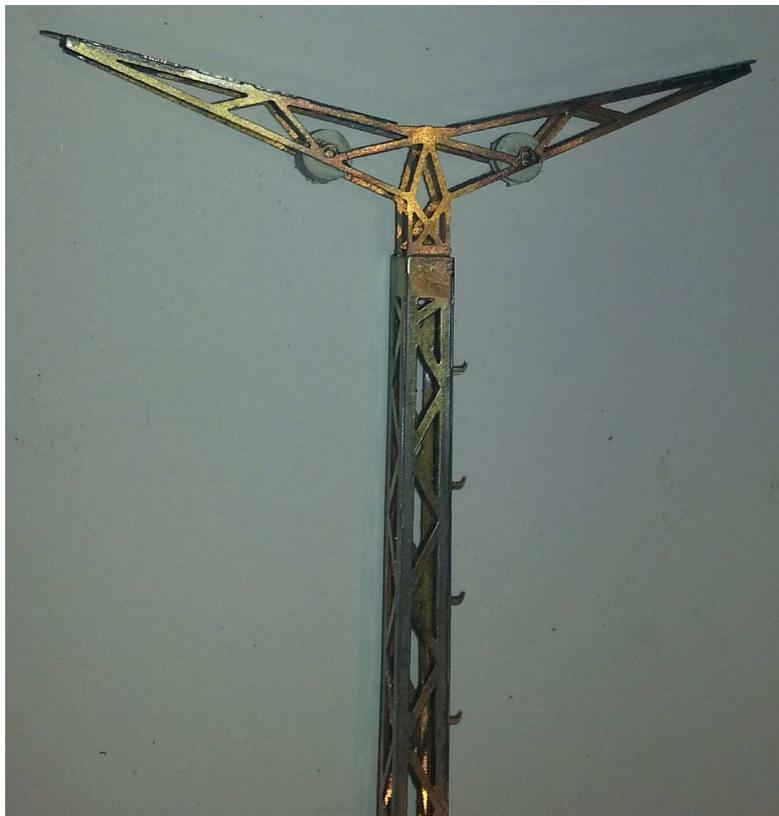
**Die LED's, wie auf dem Bild zu sehen ist, bearbeiten. Den kurzen Stift ca. 2mm oberhalb der LED abschneiden. Den langen Stift abkanten, damit die LED's mittig vom Mast sitzt.**
