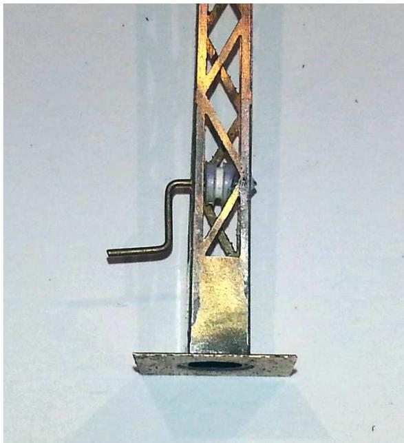
**Die zwei Rollen mit einem Stück Messingdraht in die untere Ecke des Auslegers einlöten.**
