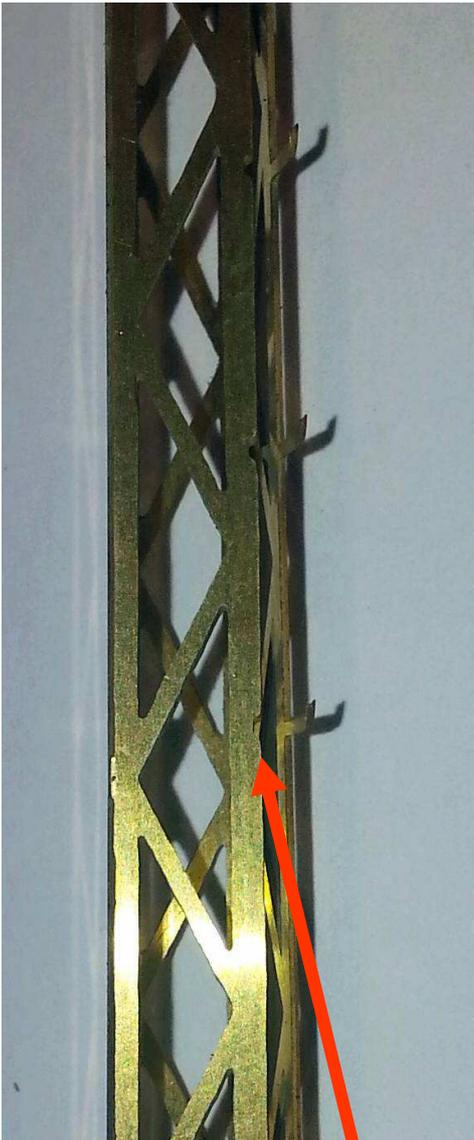
Den Mast winkelig ausrichten. Zur Ausrichtung dienen kleine Anätzungen am Gittermast.
