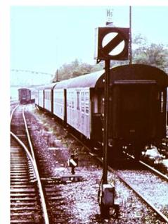
Sh1 an einem Signal der Bauform 1926 mit Blechkranz und Blech für Bezeichnungsschild
