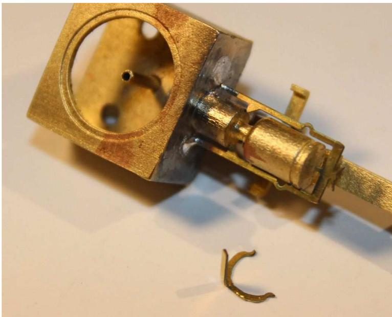
Den Befestigungsbügel scharf abkanten.
