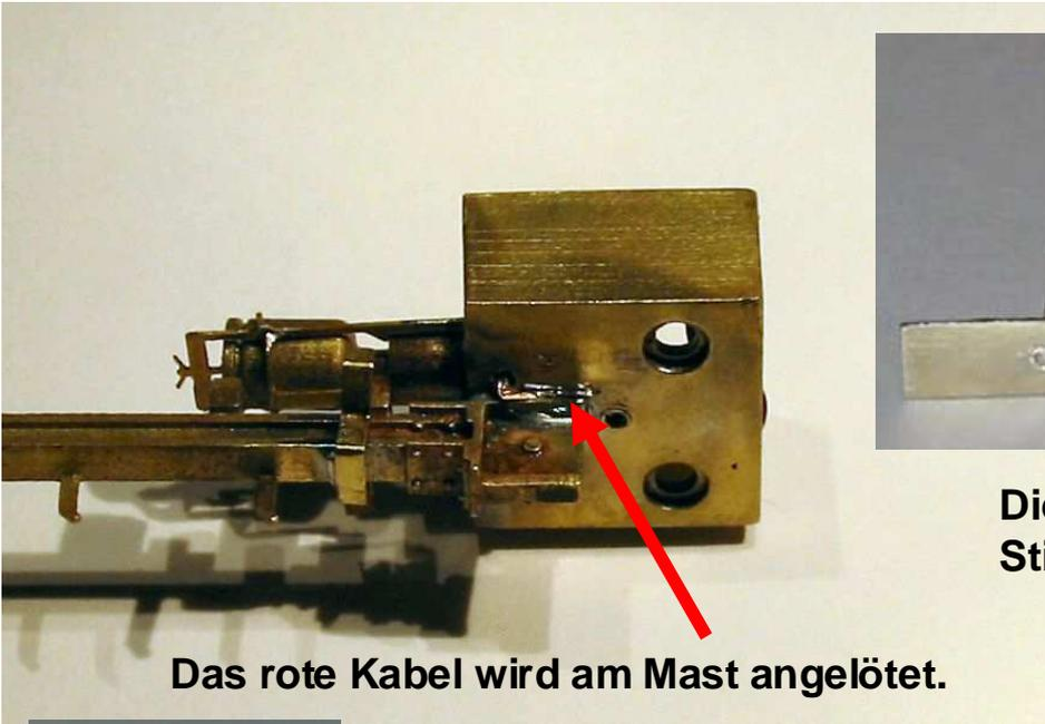
Das rote Kabel wird am Mast angelötet.
