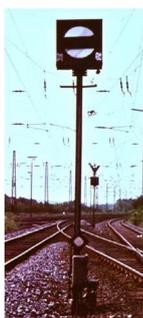
Sh0 an einem Signal der Bauform 1936 mit einfachem Balken und ohne Blech für Bezeichnungsschild
