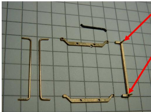
Schneiden Sie zwei Stücke Draht auf einer Länge von ca. 25 mm ab. Der Abstand der Biegekanten entnehmen sie dem Lochabstand der senkrechten Halterung.
