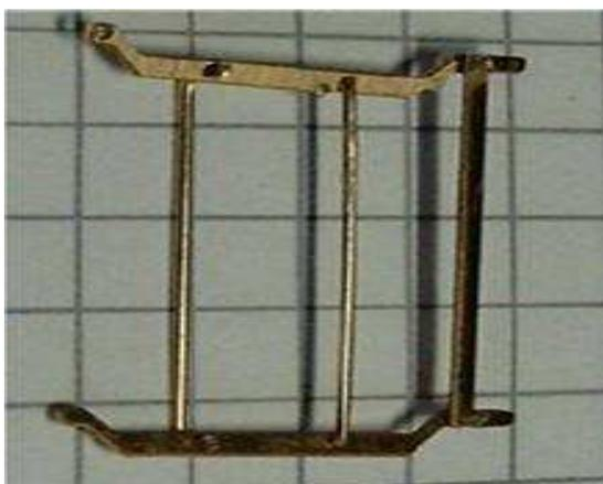
Zu Beachten ist auch, dass Sie beiden senkrechten Bügel, einmal von vorne und einmal von hinten, in die waagerechten Teile einbauen.
