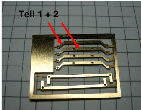
Trennen Sie Teile aus dem Blech heraus. Teil 1 und 2 sind die oberen Teile des Gitters. Zu erkennen am zusätzlichen Loch.
