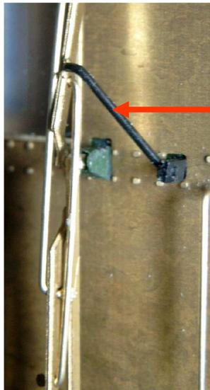
**Einsetzen des Schwenkbügels**
