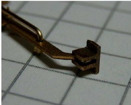
**Setzen Sie nun das Gitter in die Halterung ein. Das Profil wird mit einem Tropfen Kleber fixiert.**
