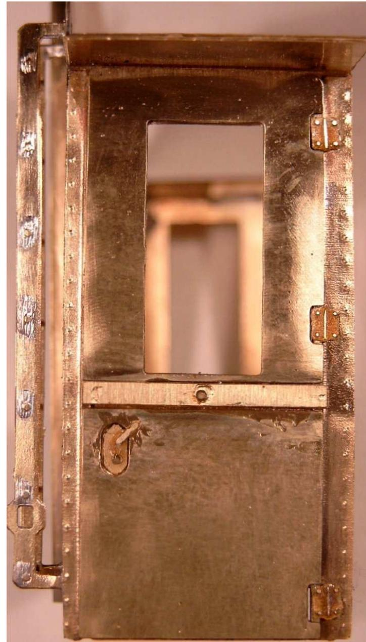
**Biegen sie das Gehäuse für die Bremskurbel nach den Bildern und setzen sie diese dann in die Anätzung der geschlossenen Bühne am andere Ende ein.**
