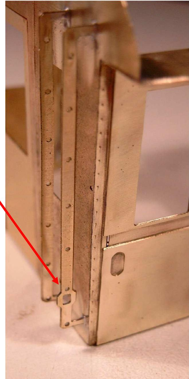
**Aus dem beigefügten 2x2 mm Messingprofil schneiden sie 2 Stücke für die senkrechten Verstärkungen und Löten diese in die vorgesehenen Anätzungen. Ein kurzes Stück muss ausgeklinkt werden und ebenfalls in die waagerechte Anätzung eingelötet werden**
