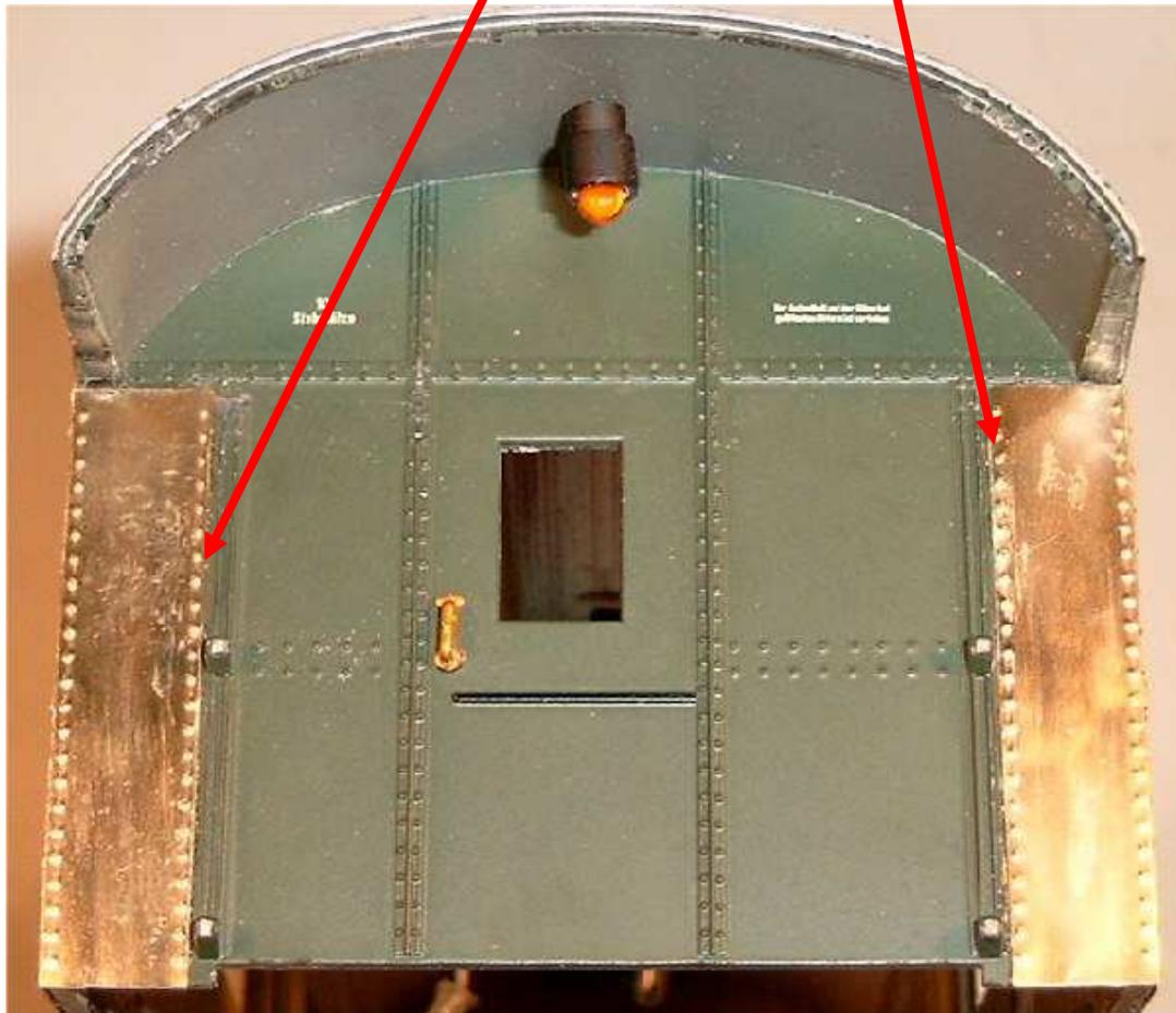
**Bevor Sie die beiden Großen Abdeckbleche (Teil 1.1 und 1.2) ankleben ein paar Tipps. Kleben Sie das Dach mit Kreppband bündig zu den Seitenteilen ab. Darauf aber achten, dass das Klebeband nicht übersteht.**
