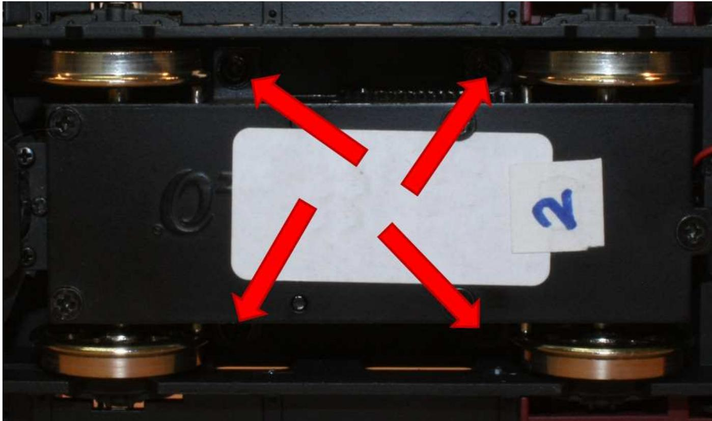
Der Antriebsblock wird mittels Kontakfedern mit Strom versorgt, also behindern keine Kabel die Demontage.
