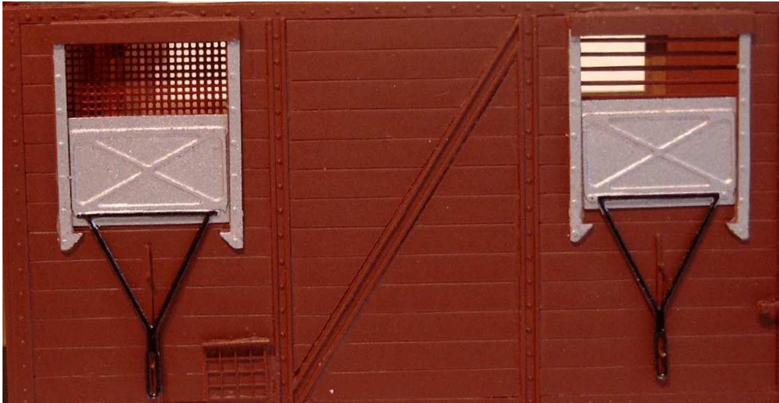
Beim abschließenden Aufsetzen des Daches darauf achten, das die Dachführungen oberhalb der Lüftergittern genügend weit eingeschnitten sind, sonst entsteht ein Spalt zwischen Wand und Dach!
