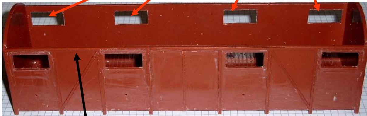
Demontieren Sie das Fahrgestell, das Dach und die vorhandenen Lüfterklappen.
