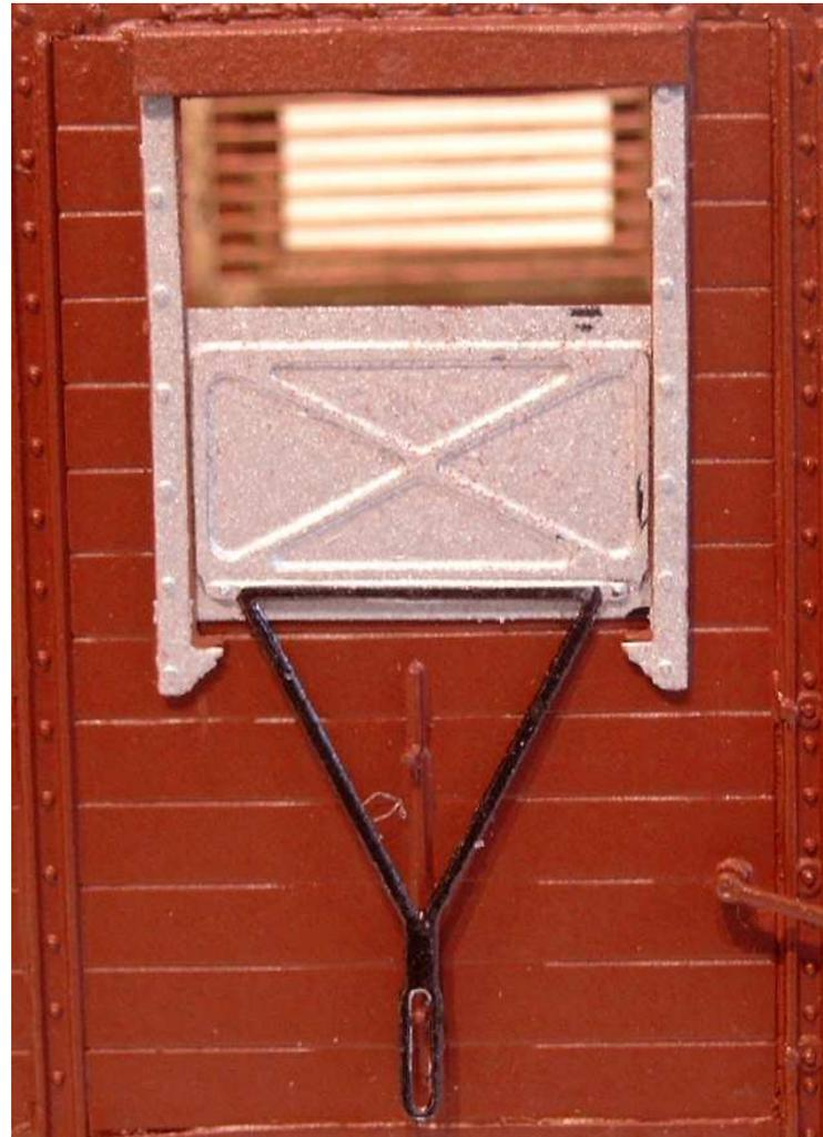
Zu guter letzt werden noch von hinten die Lüftergitter eingeklebt.
