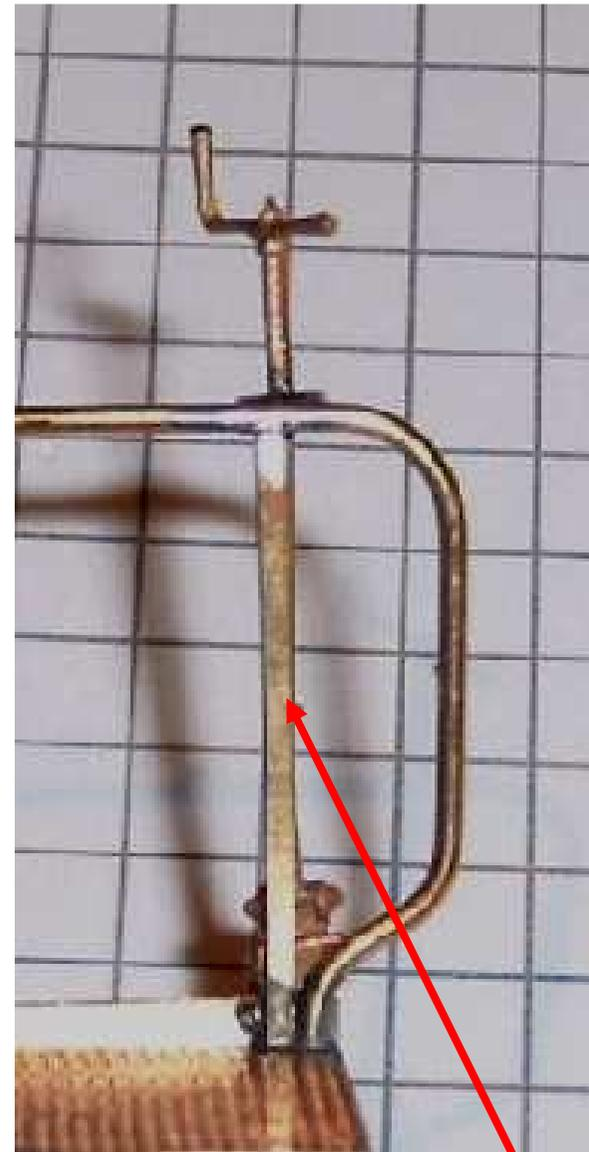
**Setzen Sie jetzt hinter der Bremskurbel das geätzte U-Profil ein.**
