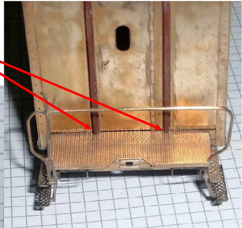
**Befestigen die Rangiergriffe an den Pufferbohlen. Mit den beigefügten Messingdraht biegen Sie die Haltegriffe und setzen sie diese in die Eckstützen ein.**
