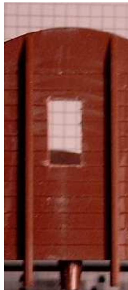
**Kleben Sie jetzt die Bleche, wie vorher beschrieben, auf die abgeschliffenen Seitenwände.
