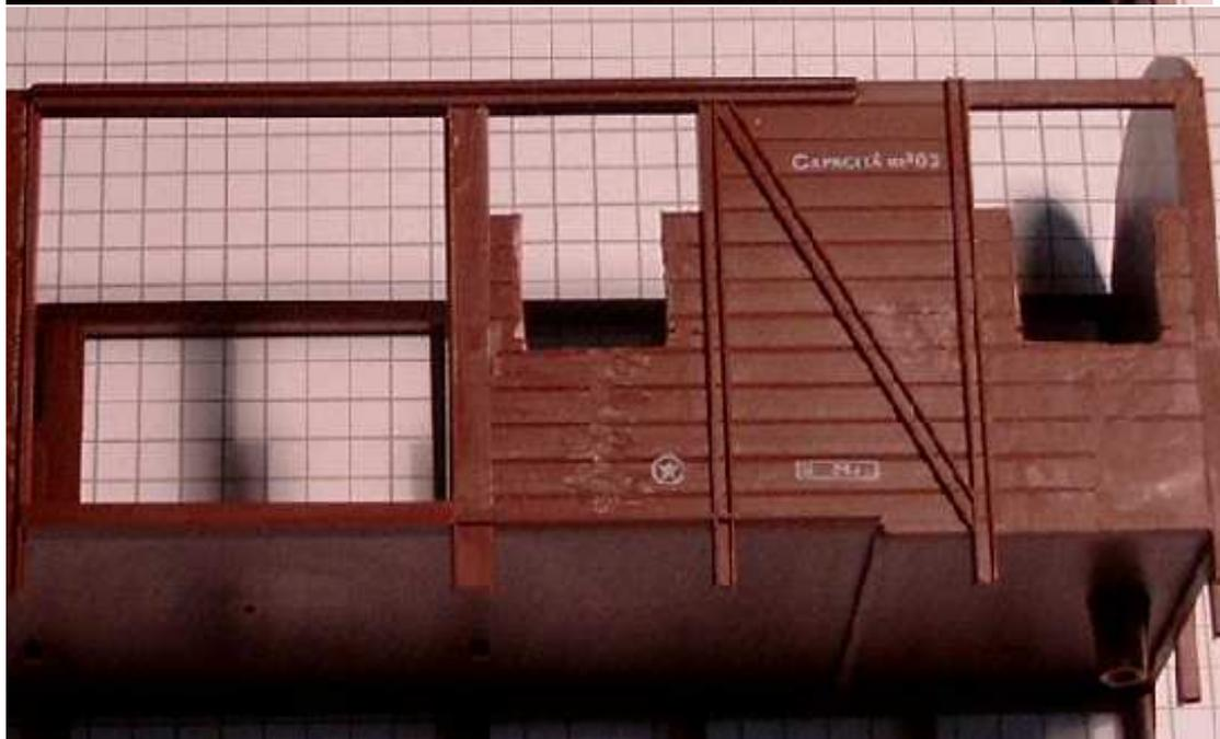
**Trennen Sie die Teile 3 / 4 und 10 aus der Ätzplatte heraus. Legen Sie diese auf das Gehäuse auf und zeichnen Sie die Umrissse der Fensterausschnitte auf. Schneiden Sie die Ausschnitte soweit heraus, dass die mitgelieferten Fenster hinein passen.**
