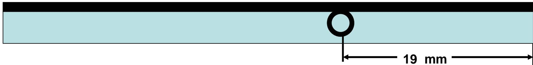
Trennen Sie den Fingerhaken aus dem Blech heraus. Schneiden Sie ein Stück Messingdraht 0,5 mm auf die passende Länge. In das Loch des Einfingerhakens löten Sie dann den Messingdraht ein.
