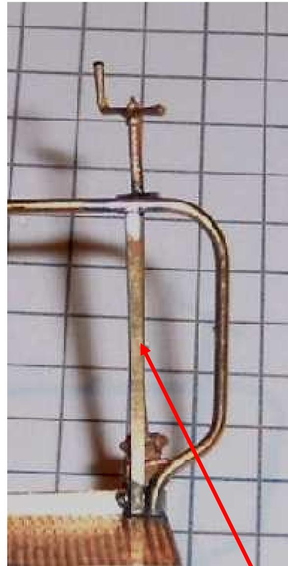
**Setzen Sie jetzt hinter der Bremskurbel den Verstärkungsträger ein**
