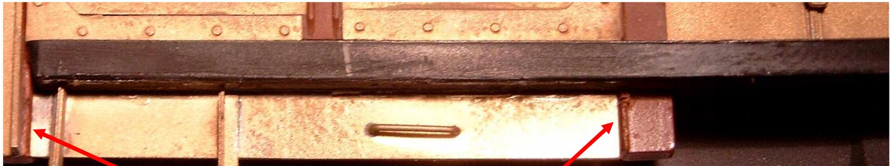
Setzen Sie die schwarze Bodenplatte unter das Gehäuse. Das Abschlussblech bündig mit den Senkrechten Trägern unter die Bodenplatte aufkleben.
