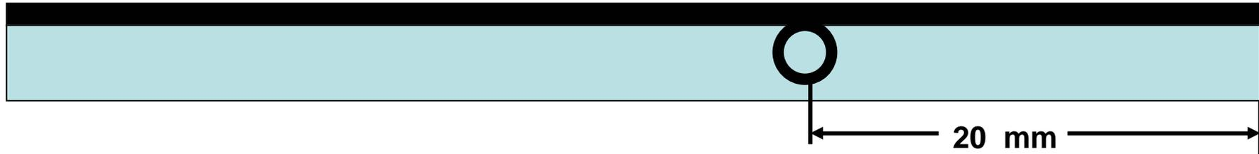
Trennen Sie jetzt den Einfingerhaken (Teil 6.1) aus dem Blech heraus. Schneiden Sie ein Stück Messingdraht 0,5 mm auf passende Länge. In das Loch des Einfingerhakens löten Sie dann den Messingdraht ein. Bohren Sie jetzt das Loch am Winkel auf und setzen Sie den Einfingerhaken ein.
