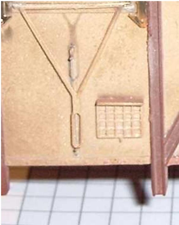
**Die Zettelhalter (Teile 14) heraustrennen. Das hintere Blech nach vorne abkanten. Das Gitter aufkleben. Den Zettelhalter in das linke Feld, auf der rechten Seite des Feldes anbringen.**
