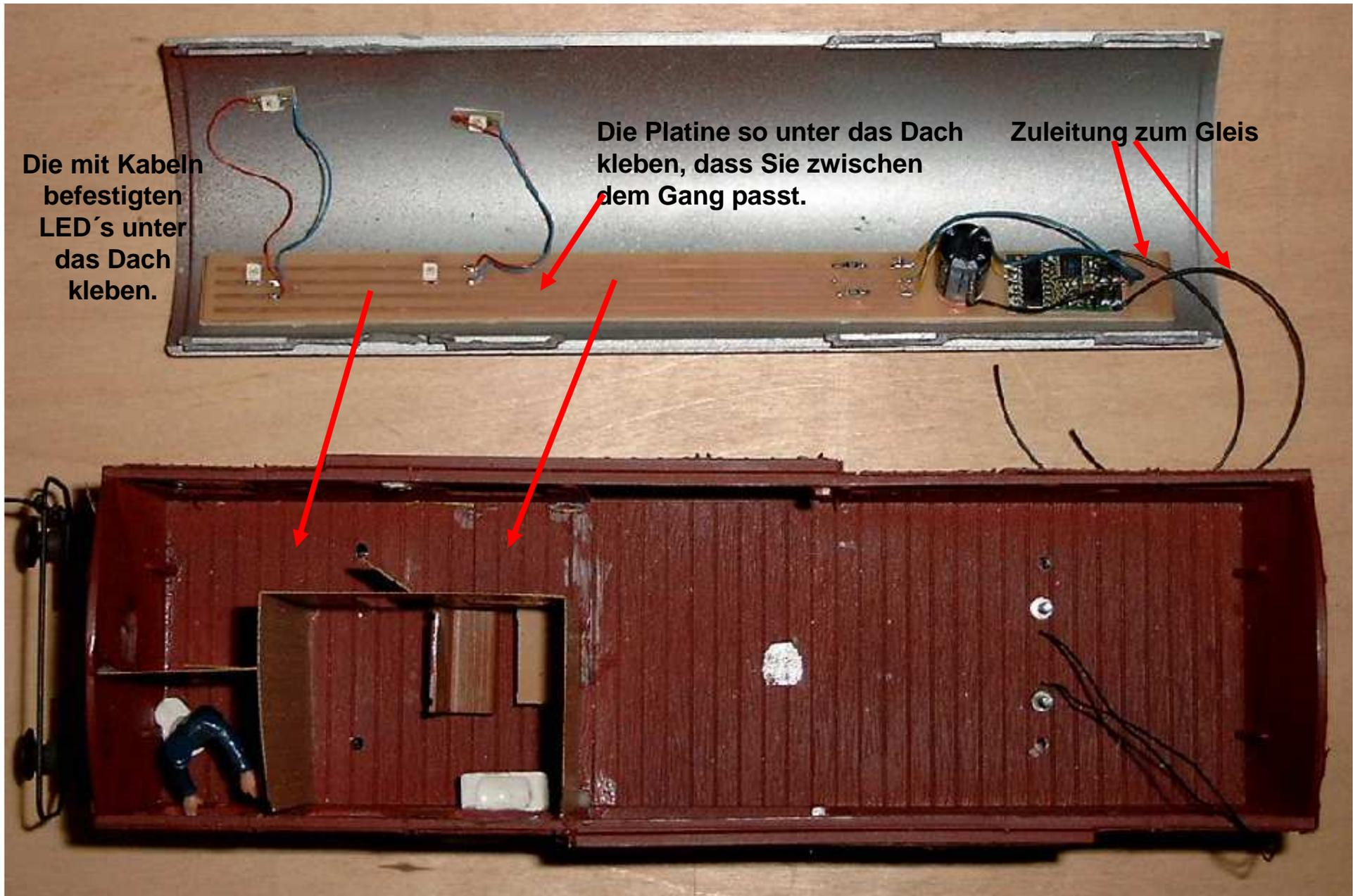
Die mit Kabeln befestigten LED's unter das Dach kleben.
