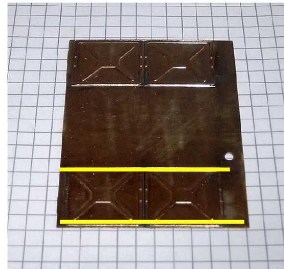
**Bohren Sie jetzt mit eine 0,5 mm Bohrer die Löcher an den Motorklappen auf.**
