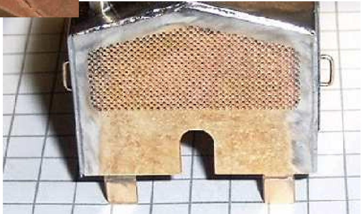
**Jetzt kann man das komplette Oberteil schon einmal zur Probe auf den Fahrwerksrahmen aufstecken.**
