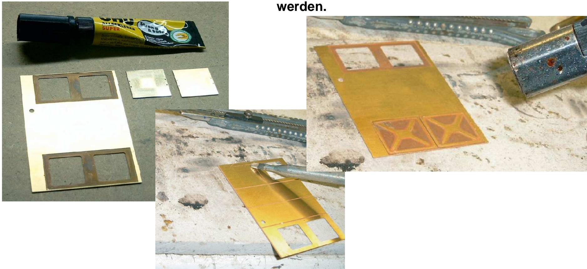
Die einzelnen Bauteile sollten erst aus dem Blech herausgetrennt werden, wenn sie benötigt werden. Diese können Sie entweder mit einem Seitenschneider oder einem Cuttermesser heraustrennen. Dazu legen Sie das Blech auf eine harte Unterlage. Hier wurde Presspappe aus dem Baumarkt verwendet.
