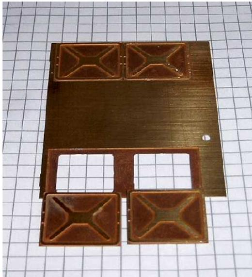
**Trennen Sie Teil 1 und die Teile 2 heraus. Legen Sie die Teile 2 in die Aussparung von Teile 1 und verlöten oder verkleben diese.**
