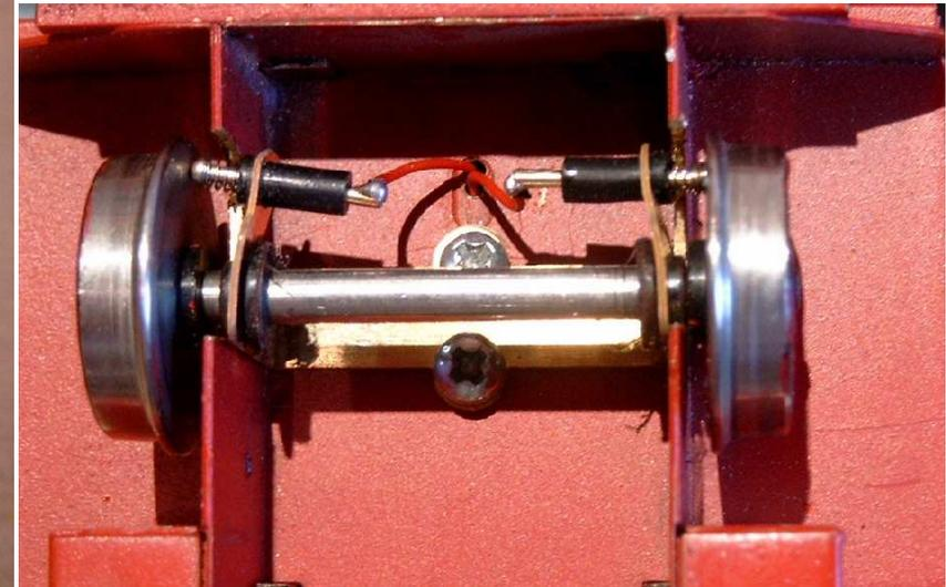
Den Motor mit den beiliegenden Blechschrauben leicht festziehen.
