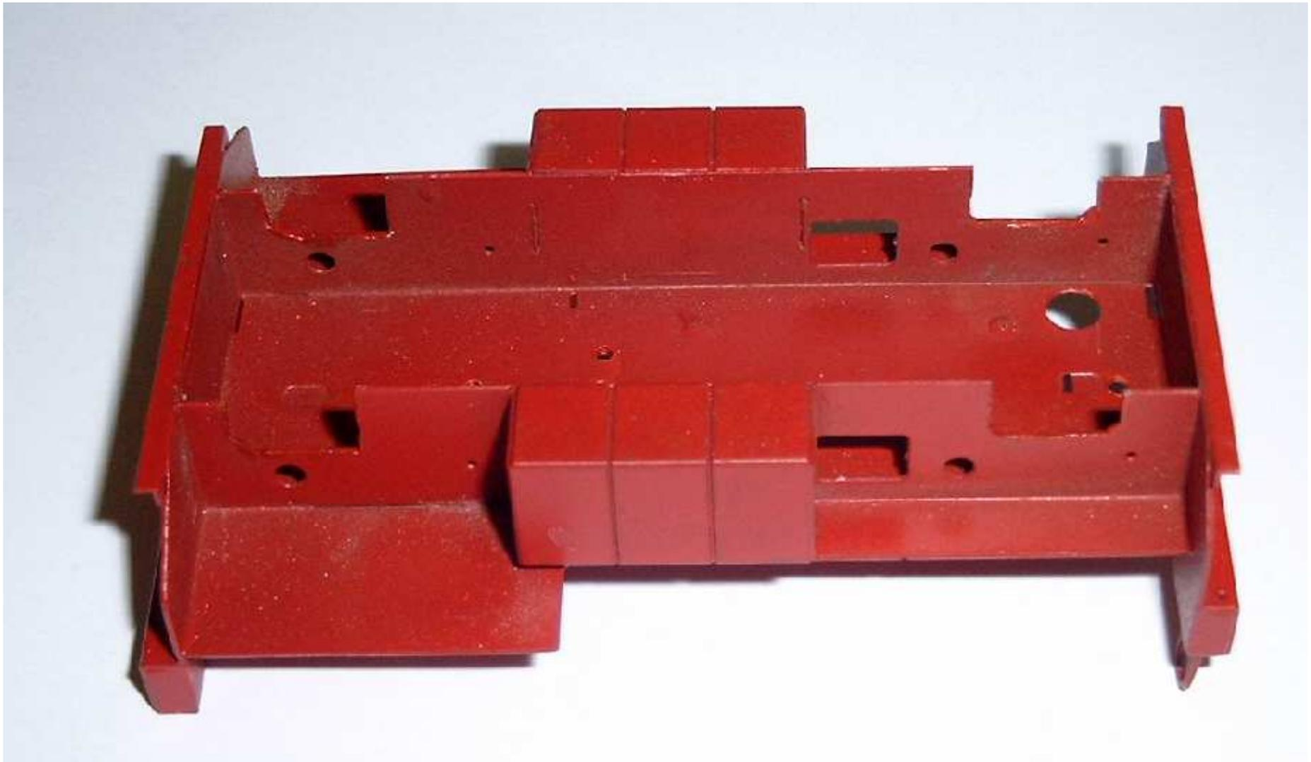
Für die neuen Bremsklötze muss ein neues Loch gebohrt werden - 2 mm außerhalb des vorhandenen Lochs. Dort hinein werden die Niete geklebt, die im Beutel mit den Bremsklötzen beiliegen. Die Niete etwas kürzen und die Bremsklötze aufstecken.
