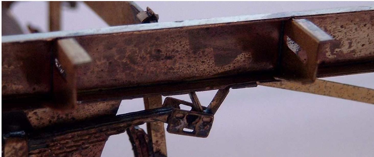
**Die Tritthalterung in die Löcher einsetzen und verlöten. Das Sprengwerk in die Anätzungen rechts und links der Federböcke einlöten. Die Trittplatte auf den Stützen befestigen.**
