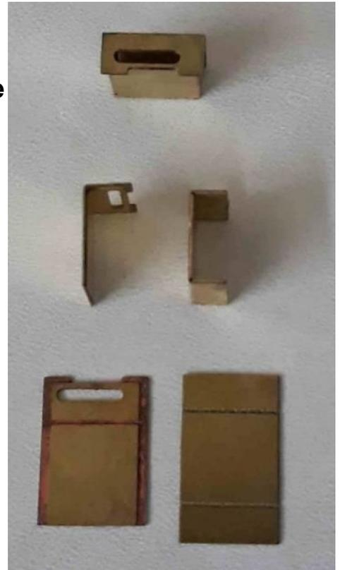
**Die Stellkiste in die Bodenplatte und an den Mast anlöten.**
