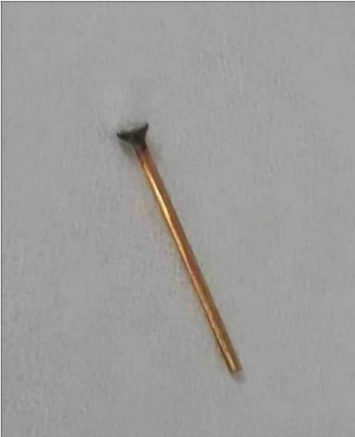
Den Stellhebel mit dem Stift in das untere Loch einschieben und den Draht am Ende flach drücken, damit er nicht herausrutschen kann.
