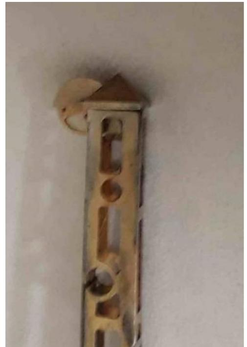
Die Röhrrchen mit einem Durchmesser von 1,3 / 1,5 / und 2,0 mm in den Mast einlöten und bündig mit dem Mast abtrennen. Das 2,5mm Röhrrchen einsetzen und einlöten. Dieses auf eine Länge von 2,0 mm abtrennen.
