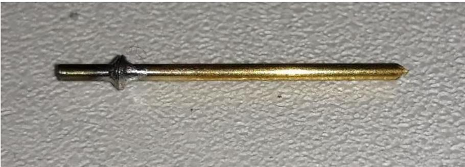
**Auf ein Stückchen 1,0 mm x 20 mm Messingdraht wird die Scheibe (11) aufgelötet. Vorne bitte 2mm überstehen lassen.**
