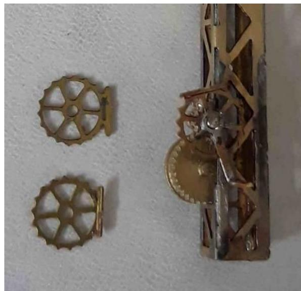
**Den Mast in die Anätzung der Bodenplatte auflöten.**
