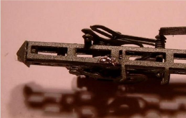
Das schwarze Kabel wird mit Hilfe eines dünnen Drahtes durch den Gittermast und das Messingröhrchen an der Bodenplatte gezogen. Das weiße Kabel wird am Gittermast verlötet. Den Lack dafür etwas abkratzen. Mit einem Pinsel die Stelle danach etwas ausbessern.
