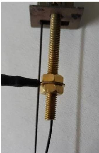
**Die Kontaktscheibe mit dem Widerstand und dem roten Kabel verlöten. Schrumpfschlauch anbringen. Die Kontaktscheibe an die Gewindestange anschrauben. Die Betriebsspannung liegt bei 12 bis 16 Volt Gleichspannung.**
