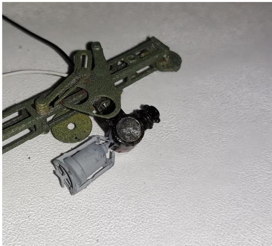
**Die Kabel der vorgefertigten Lampe werden durch die 2,5 mm dicke Hülse gezogen und die Lampe wird mit leichtem Druck aufgeschoben. Ein Verkleben ist nicht notwendig.**
