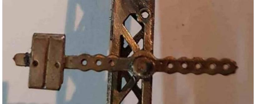
Auf ein Stückchen 0,8 mm x 20 mm Messingdraht wird die Scheibe 4 aufgelötet. 2 Stück davon. 1 Stück für die Stellhebel.
