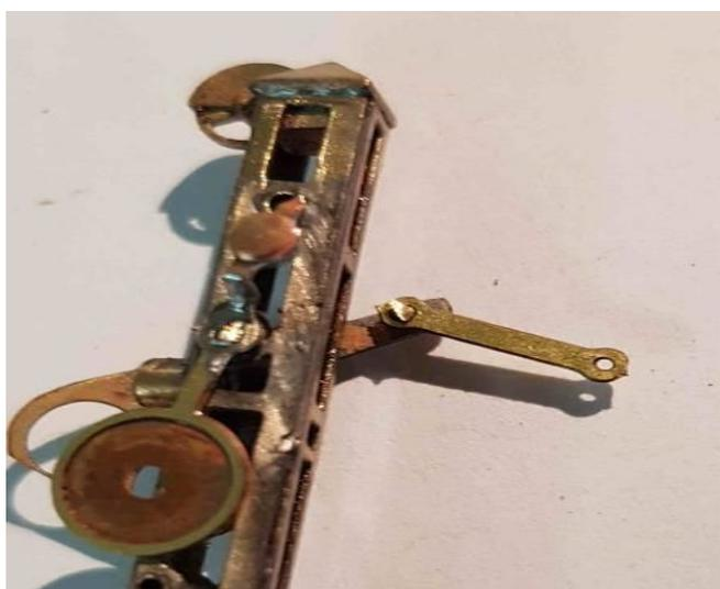
**Nach diesem Arbeitsschritt muss der Signalmast lackiert werden.**
