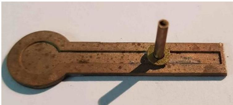
Das fertig verlötete Bauteil 8 auf den Flügel aufsetzen. Darauf achten ,dass die kleine Nase am Signalfügel anliegt.
