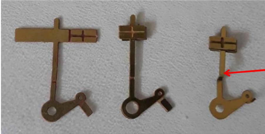
Das Bauteil 8 ,wie auf dem Bildern zu sehen ist, kanten. Die Biegekanten sollten wieder verlötet werden.
