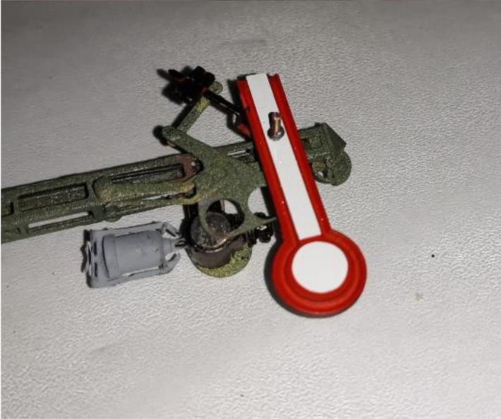
Das Signal wird mit den 1,0 mm Stiften am Mast befestigt. Auf der Hinterseite eine kleine Scheibe gegen das Herausrutschen auflöten. Achten Sie auf die Gängigkeit der Flügel.
