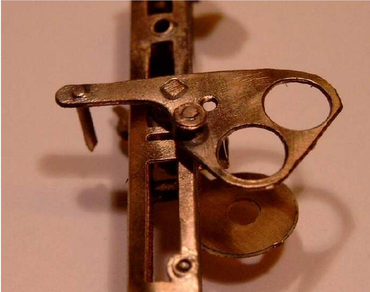
Das vorgefertigte Bauteil *e* in den Mast einsetzen. Zwischen Mast und Bauteil, 2 Scheiben *n* einschieben. Auf der Rückseite das Bauteil *m*, wiederum mit 2 Scheiben *i* aufschieben. Durch den Vierkant ist ein Ausrichten nicht mehr nötig.
