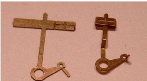
Die kleine Nase dient zur Arretierung des Bauteils auf dem Flügel.
