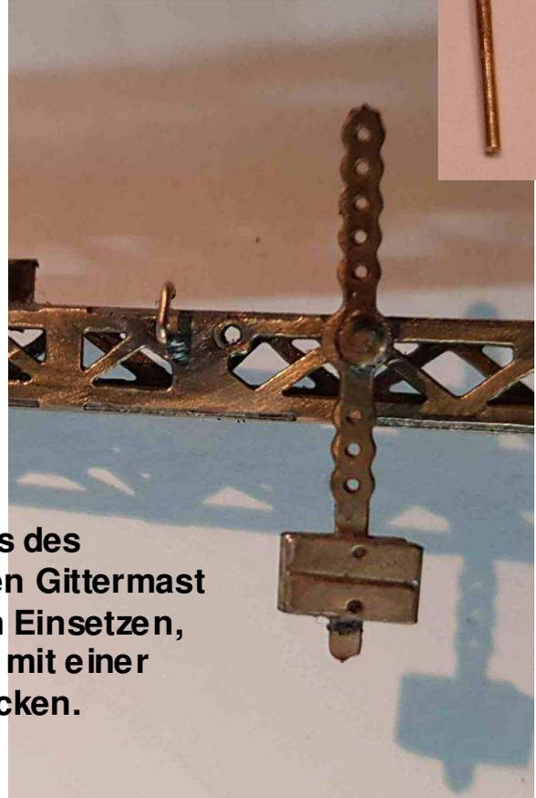
Den Kipphebel mittels des Messingdrahtes in den Gittermast einsetzen. Nach dem Einsetzen, den Draht von hinten mit einer Flachzange flach drücken.
