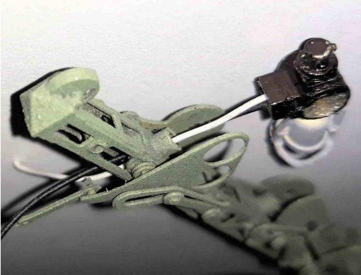
Die Kabel der vorgefertigten Lampe werden durch die 2,5 mm dicke Hülse gezogen und die Lampe wird mit leichtem Druck aufgeschoben. Ein Verkleben sollte nicht notwendig sein.
