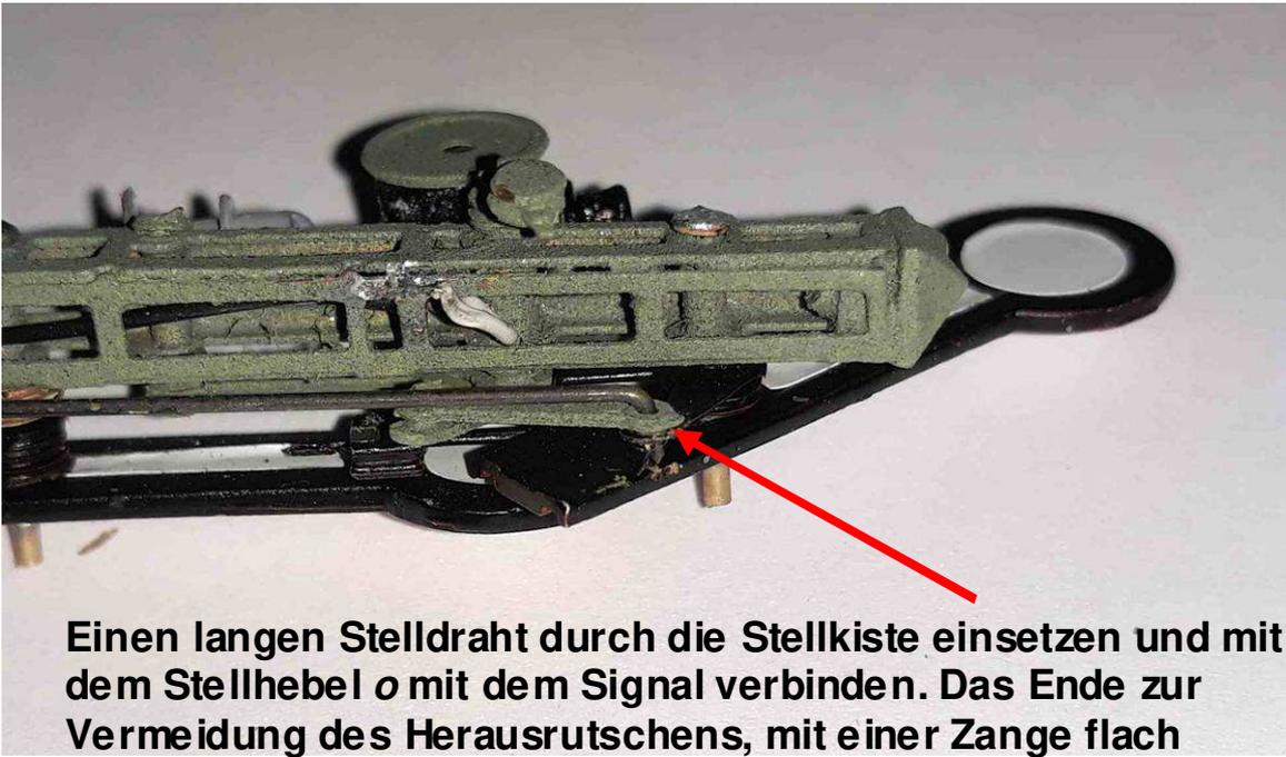
Einen langen Stelldraht durch die Stellkiste einsetzen und mit dem Stellhebel o mit dem Signal verbinden. Das Ende zur Vermeidung des Herausrutschens, mit einer Zange flach drücken.
