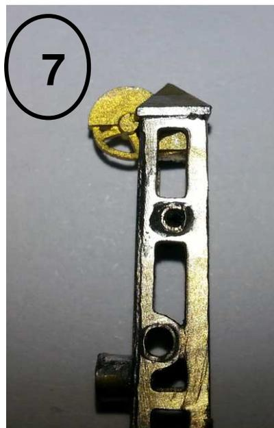
Den Mastdeckel oben auf dem Gittermast auflöten. Die Rolle gehört in die Aussparung.
