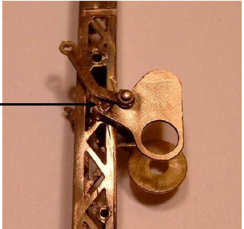
Das vorgefertigte Bauteil *f* wird in den Mast eingesetzt.
