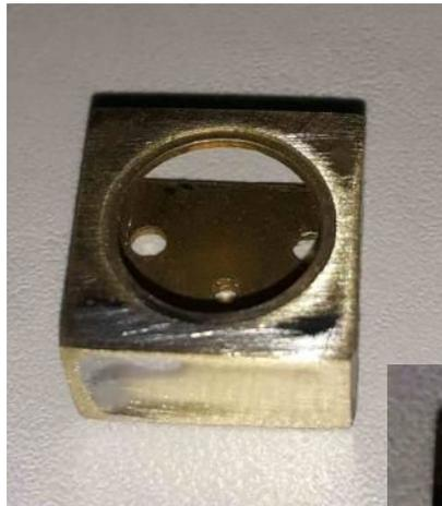
Die Grundplatte unter das Gehäuse auflöten.
