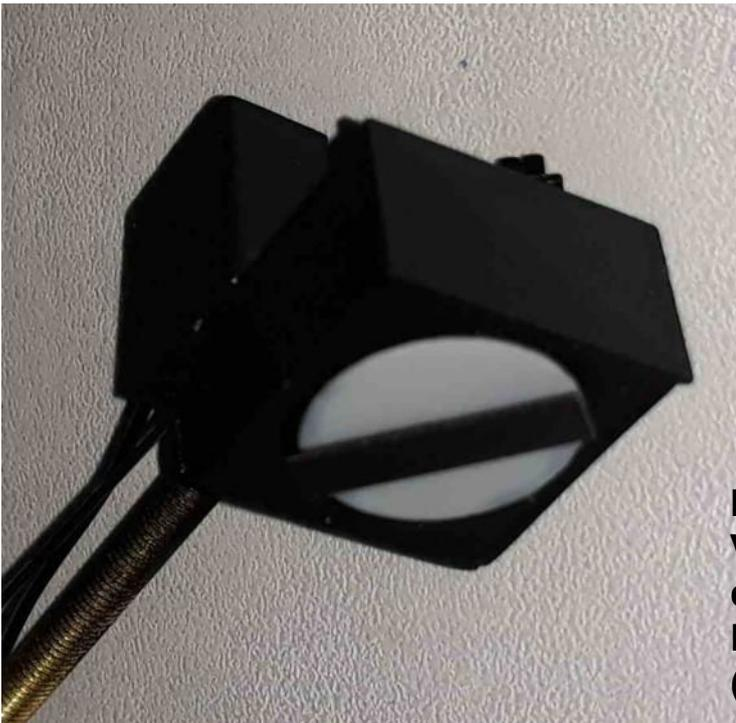
Den Deckel aufsetzen und verkleben. Vor dem Einkleben bitte darauf achten, dass sich kein Kabel vor dem Lichtdurchlass befindet. (Schattenbildung)
