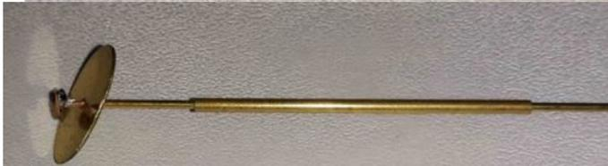
**Die kleine Scheibe auf den beiliegenden Draht (0,8mm) auflöten. Die Zentrierscheibe und das Röhrchen aufschieben. Alles zusammen in das Gehäuse einschieben und das Rohr an der Rückseite verlöten. Den Rest abtrennen.**
