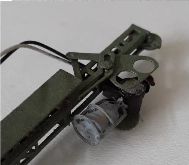
**Mit einer kleinen Zange die Lampen auf die Röhrrchen aufsetzen. Das schwarze Kabel durch den Mast nach unten hin heraus ziehen. Die weißen Kabel am Mast anlöten.**
