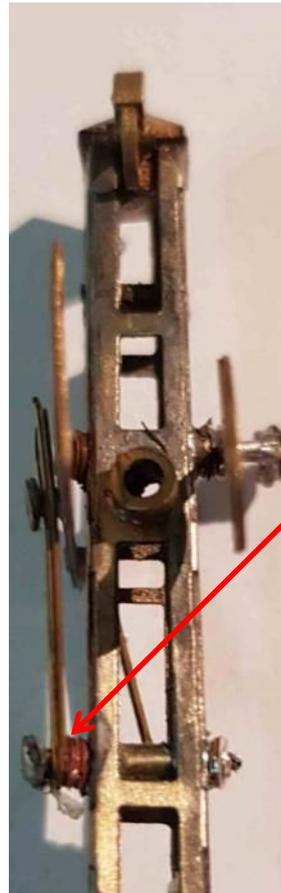
**Den Stellhebel mit dem Mast verbinden. Zwischen Mast und Stellhebel 3 Scheiben (4) einsetzen. Den Stift an der Gegenseite kürzen und flach drücken.**
