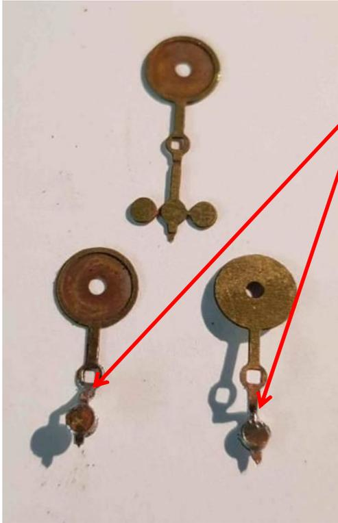
**Das Teil 5 heraustrennen und wie auf dem Bild zu sehen, kanten. Die abgekanteten Ecken mit ein wenig Lötzinn befestigen.**
