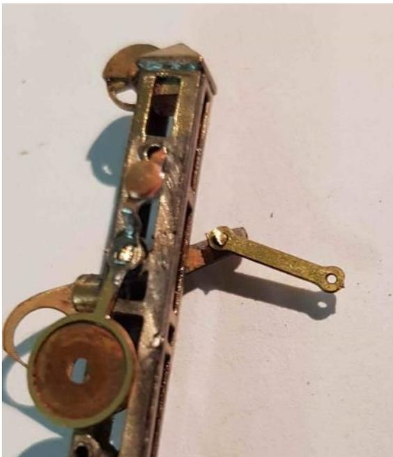
**Den Distanzhebel (12) auf das Drahtende des Bauteils A aufschieben und das Ende wieder mit einer Zange flachdrücken.**
