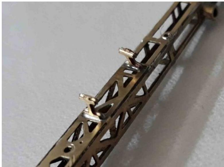
**Bauteil 3 aus dem Blech entnehmen. Die Gewichte falten. In das große Loch ein 1,3 mm Röhrchen einlöten und auf eine Länge von ca. 3 mm kürzen.**
