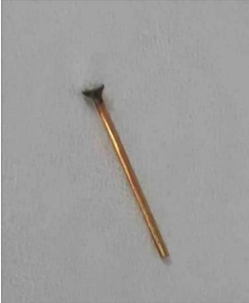
**Auf ein Stückchen 0,8 mm x 20 mm Messingdraht wird die Scheibe 4 aufgelötet. 2 Stück davon. 1 Stück für die Stellhebel.**
