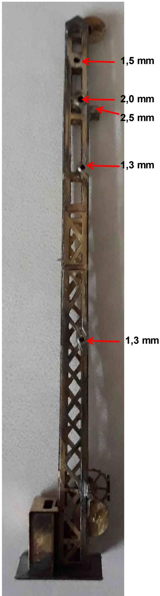
Die Röhrcchen mit einem Durchmesser von 1,3 / 1,5 / und 2,0 mm in den Mast einlöten und bündig mit dem Mast abtrennen. Das 2,5mm Röhrcchen einsetzen und einlöten. Dieses auf eine Länge von 2,0 mm abtrennen.
