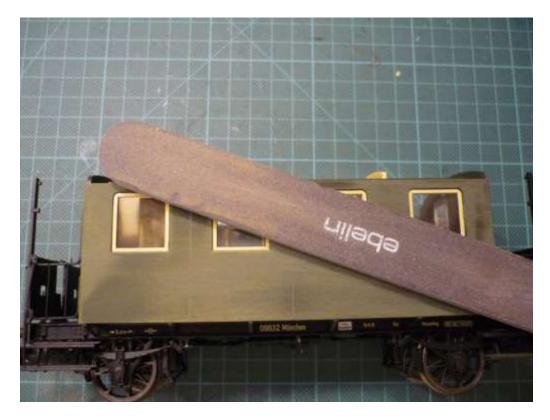
Nach Lösen von zwei Schrauben im Boden und trennen der Kabel zur Beleuchtung kann die Inneneinrichtung entnommen werden. Die Originalfenster können entfernt werden, in dem man ein Skalpell/Messer mit Gefühl zwischen Wagenkasten und Fensterband schiebt. Der Kleber ist weich und elastisch, sodass die Fenster mit ein wenig Kraft abgehebelt werden können.
