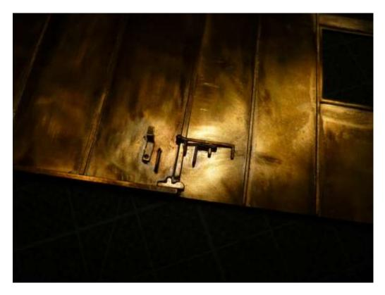
Mit den Lötarbeiten ist man jetzt soweit fertig, es kann alles für die Lackierung gesäubert und entfettet werden. Seitenwand und Türen sollten jetzt grundiert werden, die Rückseite der Türen nicht vergessen.
