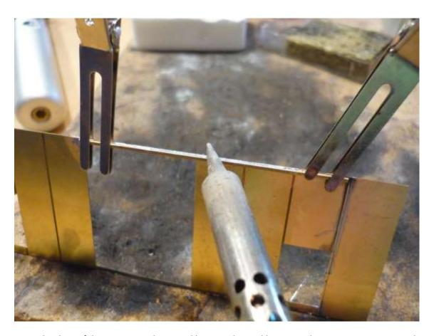
Wenn beide Türführungen eingelötet sind können die Deckleisten in die geätzten Nuten eingelötet werden. Hier auf die verschiedenen Längen achten: Die kurzen Deckleisten liegen im Bereich der Türführungen! Wichtig ist ein vollflächiges Verlöten der Deckleisten, sodass kein Spalt entsteht. Dazu ist es wichtig, dass die Teile eben und nicht verbogen sind, Klammern zum Fixieren zur Hilfe nehmen.
