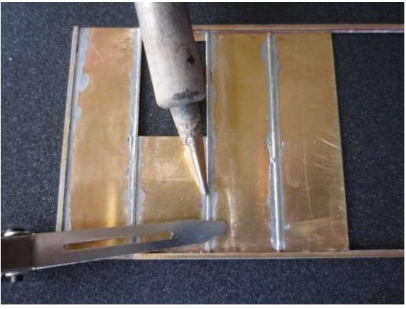
Anschließend an der rechten und linken Kante die Verstärkung auflöten. Dazu den 1 mm breiten MS-Streifen bündig mit der Außenkante ausrichten.
