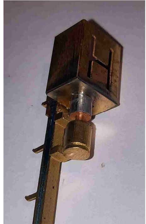
**Den Lampenkorb und die passende Halterung einlöten.**
