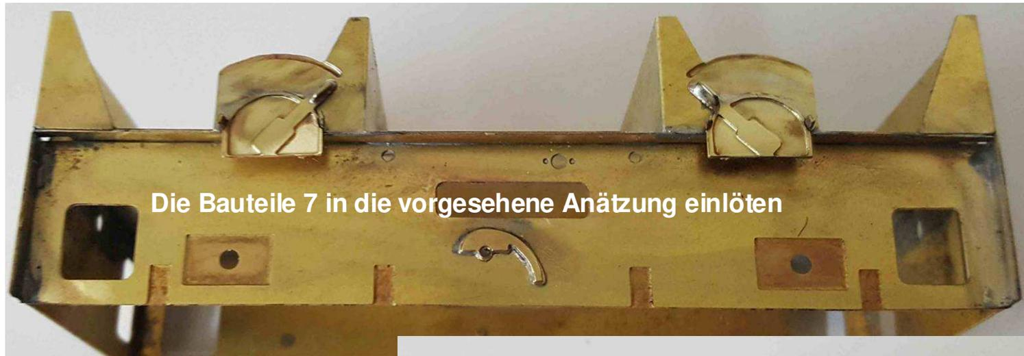
Bauteile 6, wie auf dem Bild zu sehen, abwinkeln.
