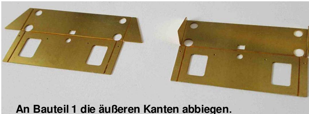
An Bauteil 1 die äußeren Kanten abbiegen.
