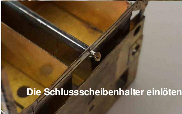
Die beigefügten Messingwinkel 1x1,5 mm in die Anätzungen an der unteren Vorderseite und Hinterseite einlöten.
