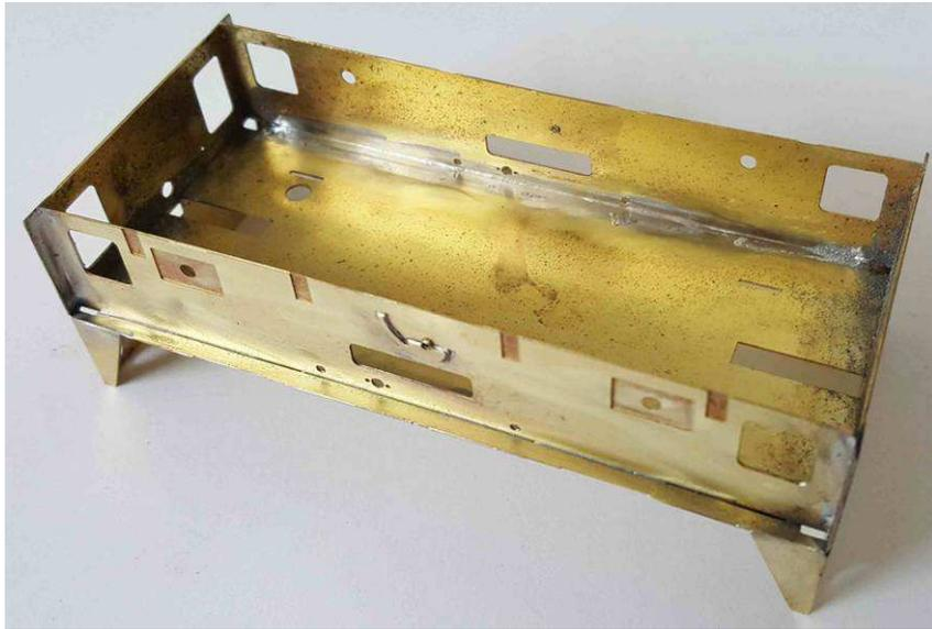
Die Bauteile 3 werden in die Anätzungen des Rahmens eingesetzt und verlötet.
