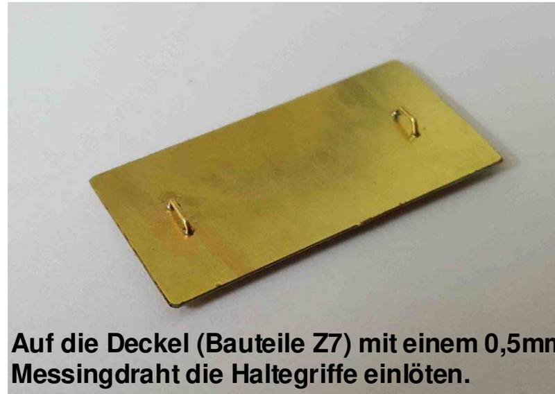
Auf die Deckel (Bauteile Z7) mit einem 0,5mm Messingdraht die Haltegriffe einlöten.
