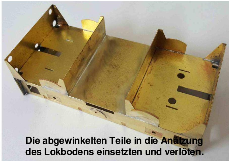
Die abgewinkelten Teile in die Anätzung des Lokbodens einsetzen und verlöten.
