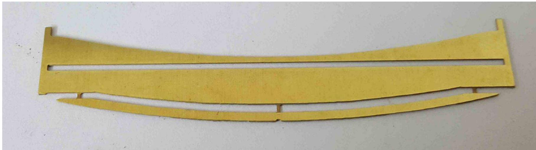
Bauteile 15 nicht vom Haltesteg trennen! Halteblech so trennen, dass jedes Teil 15 von einem Stück Halteblech gehalten wird. Siehe Bild Seite 12 rechts.
