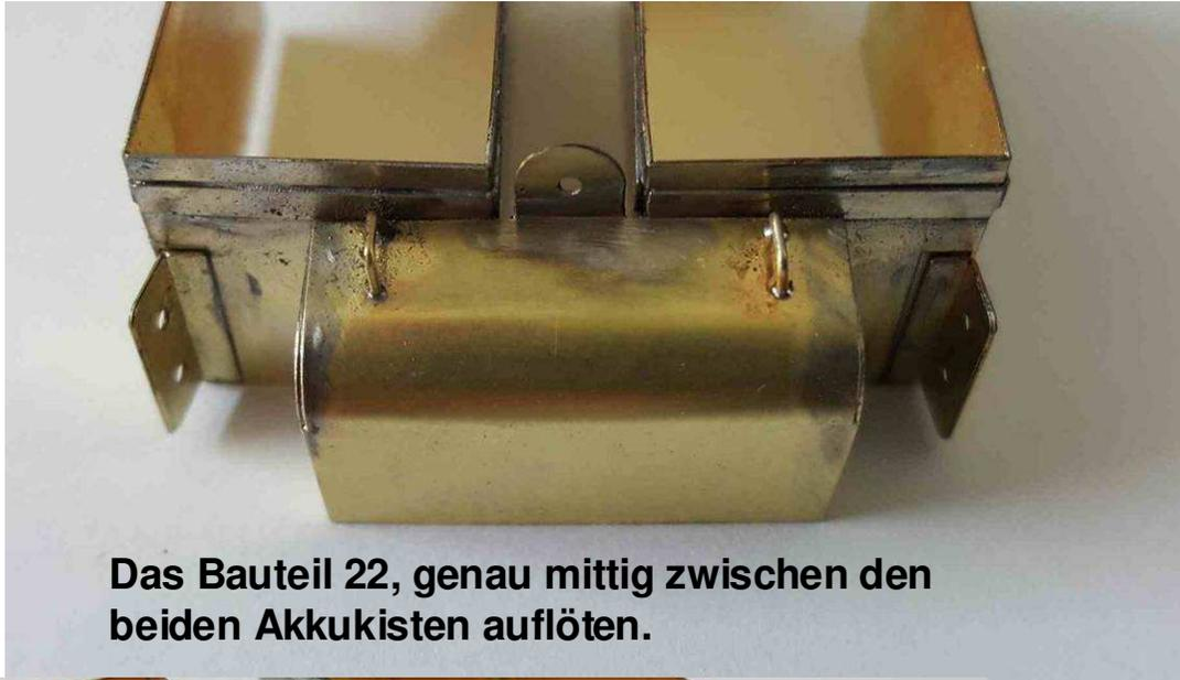
**Das Bauteil 22, genau mittig zwischen den beiden Akkukisten auflöten.**
