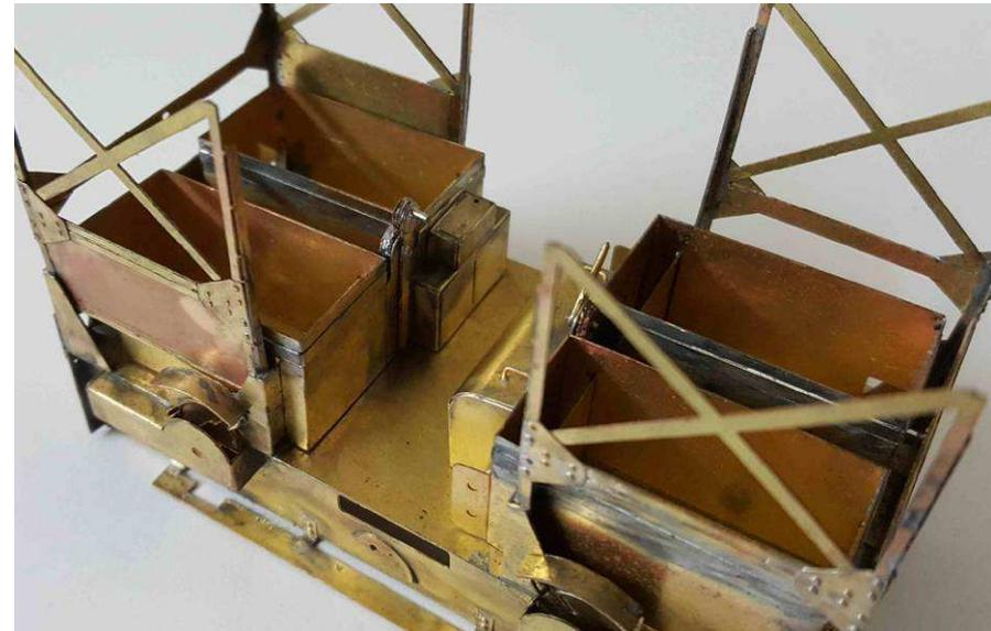
Jetzt können die Akkukisten in das Gehäuse eingeschoben werden.
