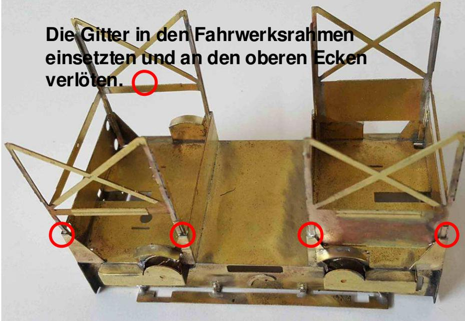
Die Gitter in den Fahrwerksrahmen einsetzen und an den oberen Ecken verlöten. ○
