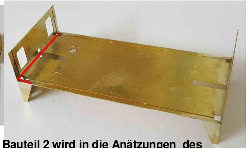
Das Bauteil 2 wird in die Anätzungen des Bauteil 1 eingelötet. **(ROT GEKENNZEICHNET)** Bitte beachten: Bauteile 2 richtige einlöten.
