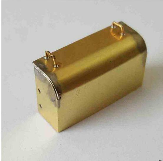
Bauteile 21 wie auf dem Bild zu sehen abkanten, wölben und verlöten. Die beiden Griffe aus 0,5mm Messingdraht einsetzen.
