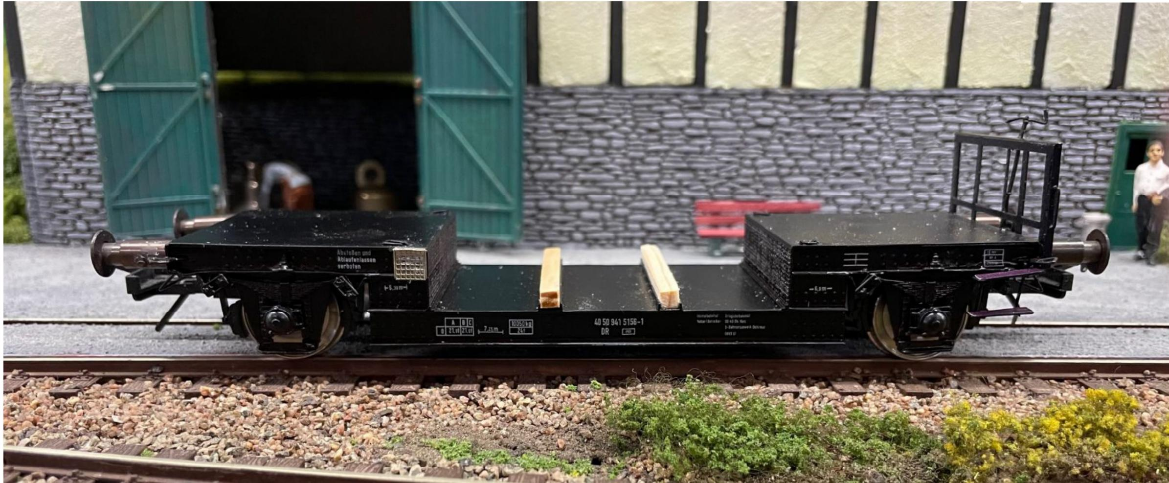
**Zweiachsiger Tiefladewagen zum Transport von kleineren Transformatoren**
